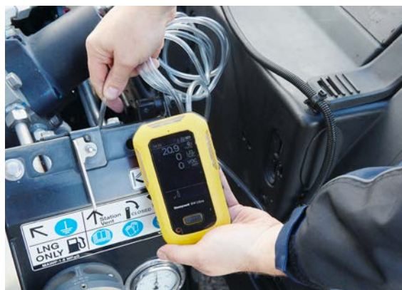
I rilevatori di gas portatili sono utili nella ricerca di perdite di gas.
