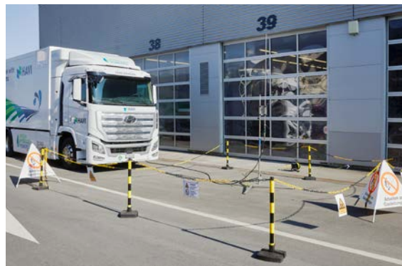
Durante lo sfiato di gas occorre bloccare l'accesso alla zona di sicurezza.
